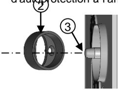
partie centrale détachable de la pièce ovale avant l'installation. Toutefois, si le mur présente des aspérités ou des trous importants (>4mm), gardez la partie centrale de la pièce ovale afin de garantir la bonne intégrité de l'autoprotection à l'arrachement. Ensuite positionnez le châssis de la SIREX en prenant soin de bien placer le capteur de surveillance d'arrachement à l'intérieur de la pièce ovale plastique. Ce système ne nécessite aucun réglage.
